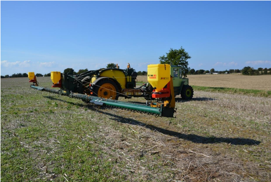
Billede 2. Danfoil sprøjtebom påmonteret 3 granulatspredere til udbringning af sneglekorn.
